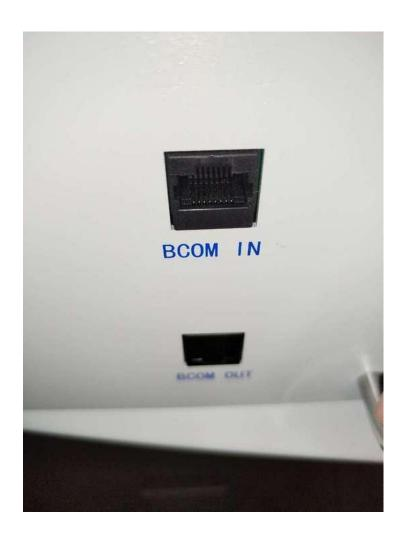
3) 拆盖检查高压盒内部,可使用万用表测量 RJ45 通讯小板与 BMS 板上的通断,以确认连接线束的好坏,若线束不通,更换线束或更换高压盒;
