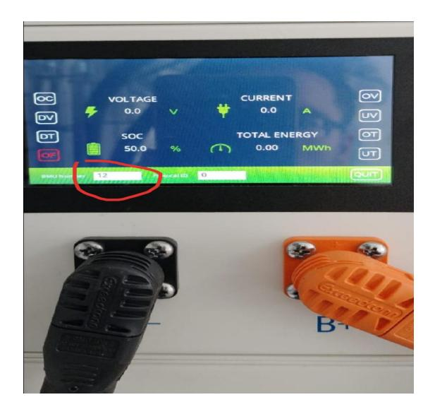
2. 如果还有故障; 把 BMU Number 改成 9 后重启设备,如果还有故障改成 8、7、6、5…….. 直到故障消失。比如 BUM Number 设置成 6 的时候故障消失了,那就是第 6 或者第 7 个电池有故障,把这个 2 个电池从簇架上拆下来,其他电池重新组装测试,看看是否还有故障,如果没有故障,把第 6 和 7 的任意一个电池和其他电池重新组装 (排在其他电池的后面组装),这样就能挑选出是哪一个电池是损坏的,检查电池上面的通讯线束和端口里面的 PIN 针是否变形,并把损坏电池的 SN 提供给工程师等待下一步指示。
